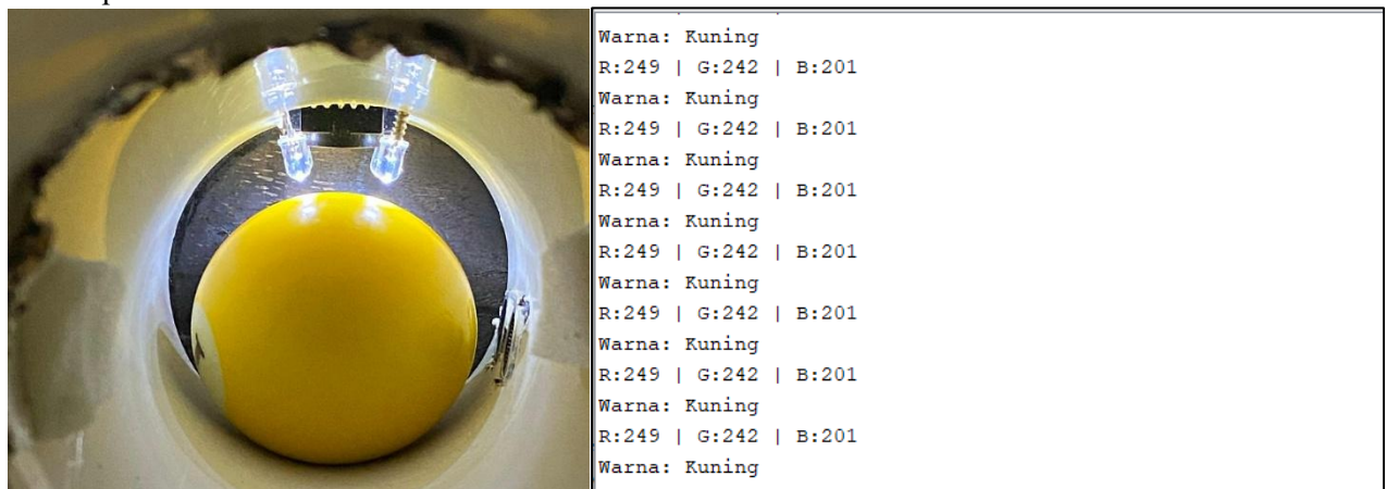
Gambar 2. Pendeteksian bola dan tampilan serial monitor
