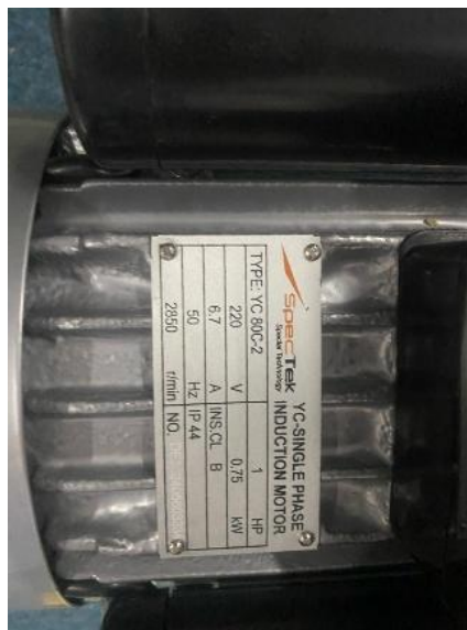
Gambar 3. Name Plate Motor Induksi 1 fasa
