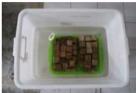
Gambar 3. Perendaman benda uji dalam larutan NaCl metode statis
