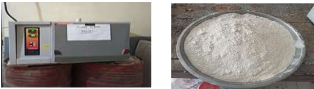
Gambar 1. a) Tanur untuk kalsinasi kaolin b) Metakaolin yang dihasilkan dari kalsinasi
