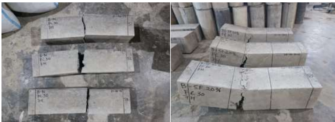
Gambar 10. Perbandingan Hasil Kuat Lentur Pada Balok Normal & Balok Dengan Penambahan Steel Fibre
