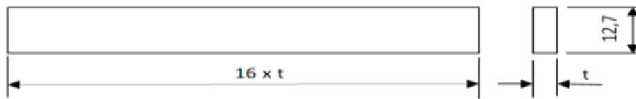
Gambar 3. Dimensi Spesimen Uji Kuat Lentur ASTM D 790 – 02
