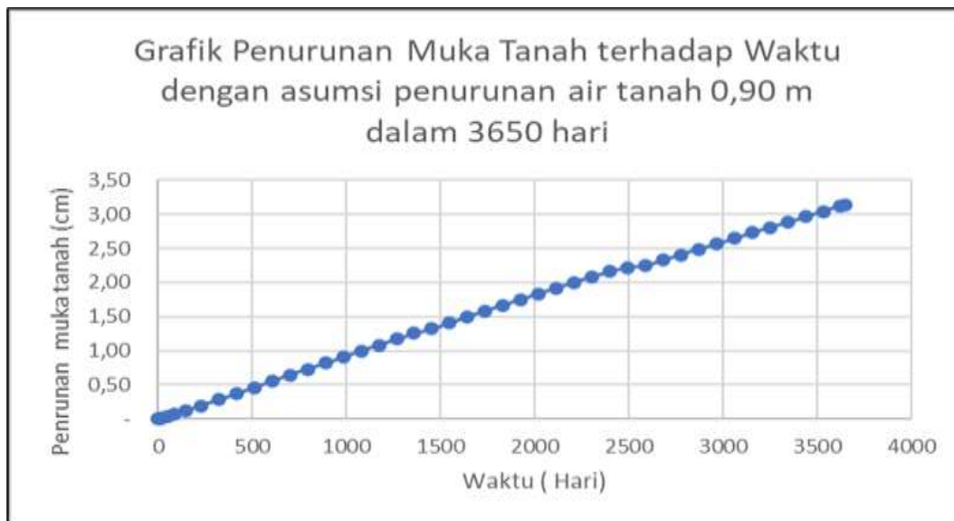
Gambar 6. Grafik Penurunan Muka Tanah dan waktu dengan asumsi penurunan air tanah 0,90 m dalam 3650 hari.
