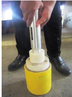
Gambar 3. Alat kalibrasi hammer test anvil yang digunakan
