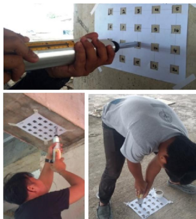
Gambar 4. Pengujian hammer test untuk elemen kolom, balok dan pelat
