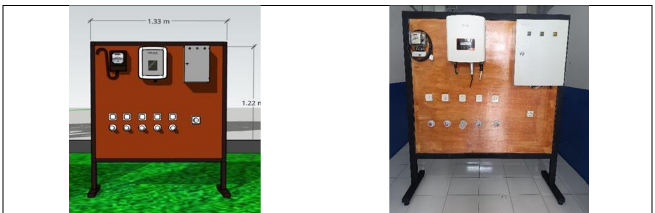
Gambar 2. Rancangan dan hasil produk Blok Simulasi beban
