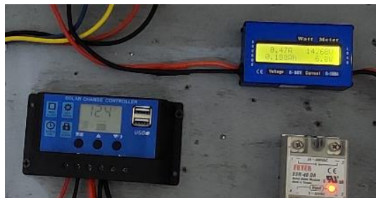
Gambar 3.2. Pengujian daya output panel surya menggunakan watt meter
