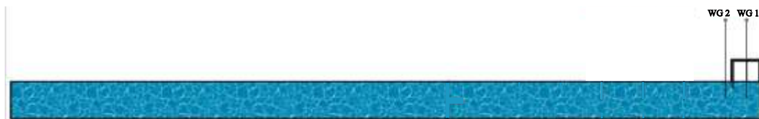
Gambar 4. Skema penempatan wave gauges (WGs) pada NWT
