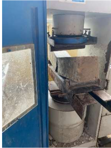
Gambar 4. Pengujian kuat lentur RCC
