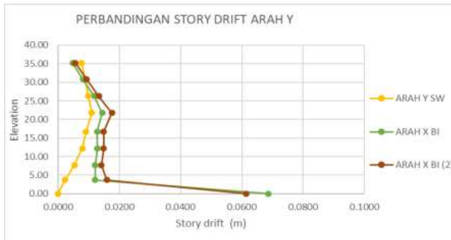
Gambar 4. Perbandingan Story drift Struktur, shear wall dan Base isolation Arah Y
