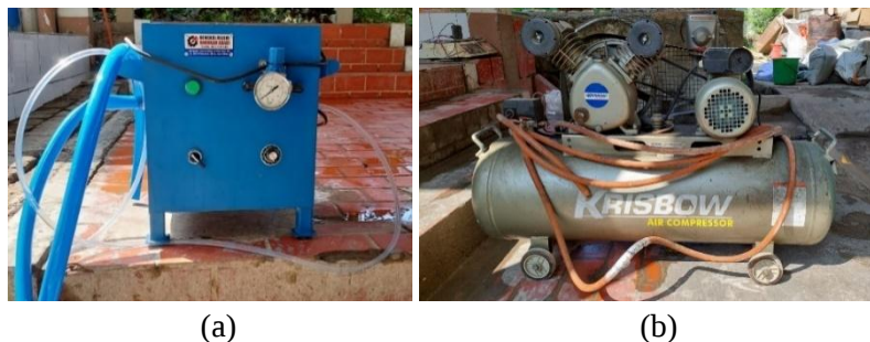
Gambar 1. Alat pada Campuran Mortar Busa (a) Foam Generator (b) Kompresor
