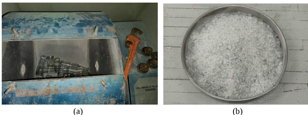
Gambar 3. Proses Pembuatan Serbuk Kaca (a) Pemecahan Botol Kaca pada Mesin Abrasi Los Angeles (b) Hasil Serbuk Kaca
