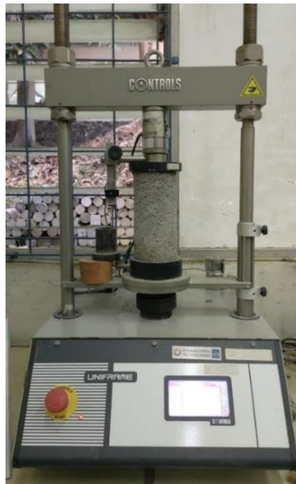
Gambar 7. Pengujian Kuat Tekan
