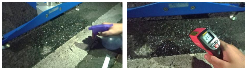
Gambar 7. (Kiri) Membasahi Permukaan dan (Kanan) Mengukur Suhu Permukaan
