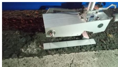
Gambar 6. Mengukur Panjang Bidang Kontak
