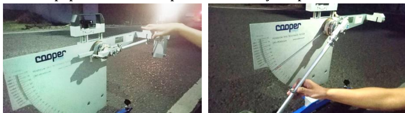
Gambar 8. (Kiri) Menekan Pelepas Pendulum dan (Kanan) Menangkap Batang Pendulum
