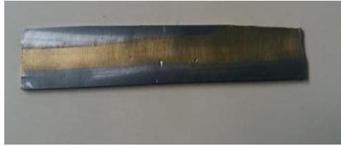
Gambar 10. Struktur logam Las filler metal kawat kuningan
