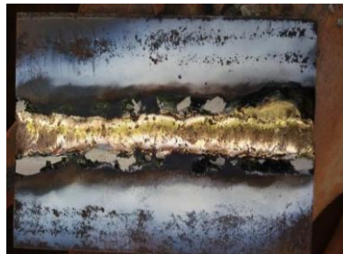
Gambar 9. Pengelasan dengan filler metal kawat kuningan
