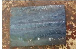
Gambar 7. Pengelasan dengan Filler Metal kawat galvanis
