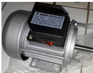
Gambar 1. Motor Penggerak Satu Fasa Tipe Bison200 beserta data name plate yang tertera pada bodi motor tersebut diatas
