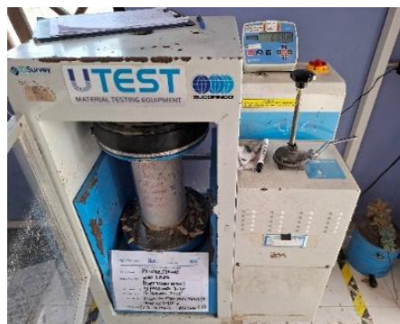
Gambar 2. Pengujian Kuat Tekan Beton
