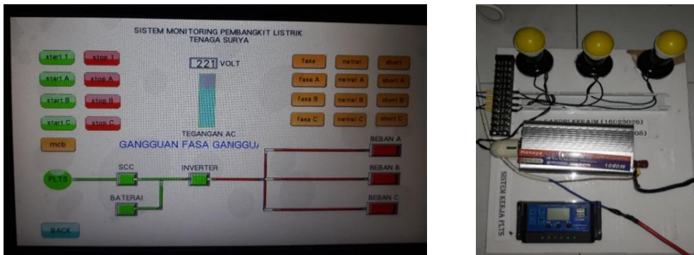
Gambar 8. Gangguan fasa pada sistem kerja PLTS dan simulasi gangguan fasa
