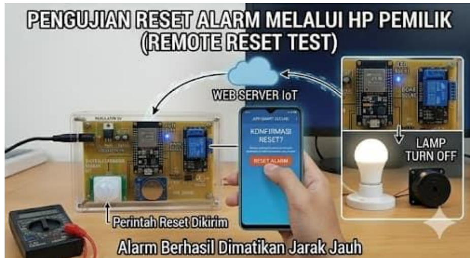
Gambar 8. Pengujian reset alarm jarak jauh melalui smartphone pengguna
