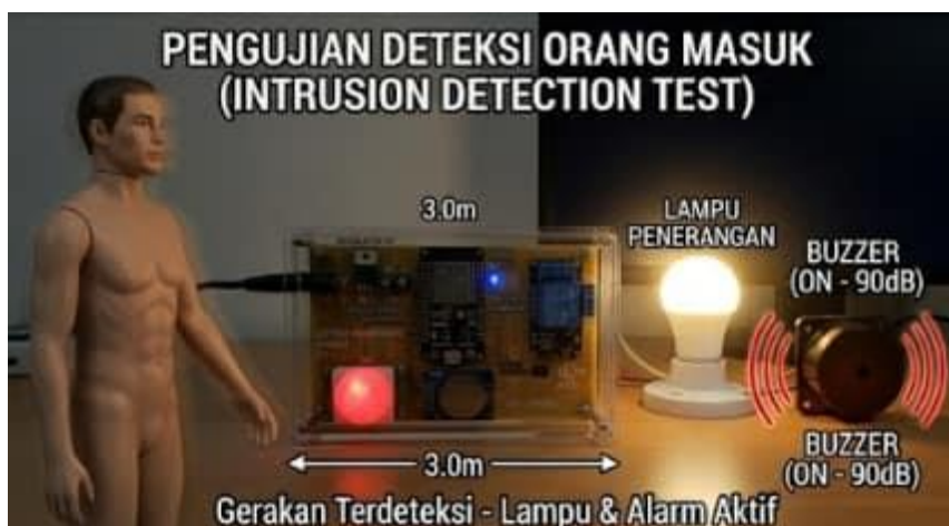
Gambar 7. Hasil pengujian saat sensor PIR mendeteksi ada orang dalam ruangan.
