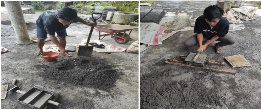
Gambar 2. Campuran Ampas Tebu dan Pencetakan
