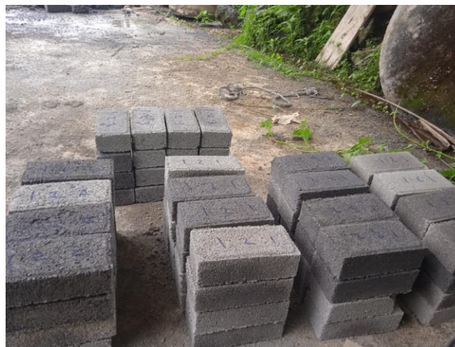
Gambar 3. Campuran Paving Block Setelah Dicetak
