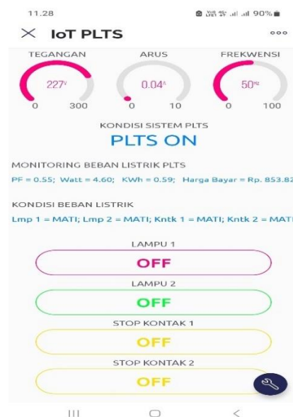
Gambar 6. Proses monitoring kondisi output dan pembebanan dari sistem PLTS secara realtime melalui perangkat Smart Phone
