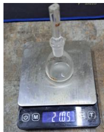
Gambar 3. Pengukuran Densitas Berdasarkan ASTM D 2320-98
