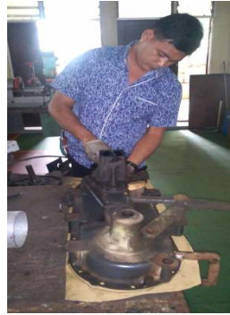
Proses Perbaikan dan Perawatan Gigi Transmisi Mesin Traktor Tangan
