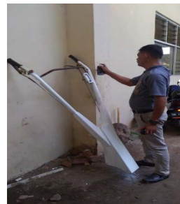
Proses Pengecatan Rangka Mesin Quick 1000 Yang Kedua
