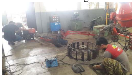
Proses Perbaikan Roda Traktor Tangan Quick G – 1000
