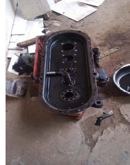
Perbaikan dan Perawatan Gigi Transmisi dan Pengantian Bearing Pada Sistem Transmisi Mesin Traktor Quick 1000 yang Kedua
