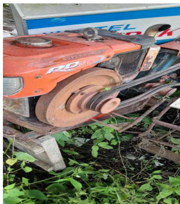
Mesin Traktor Tangan yang sudah rusak baik Mesin maupun Roda
