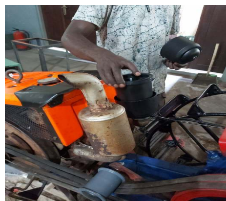
Proses Pengantian Saringan dan Filter Oli serta Pengantian Oli Pelumas
