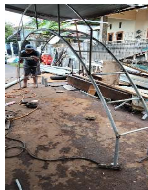
Gambar 3.a. Proses manufaktur Tangga Lengkung.
